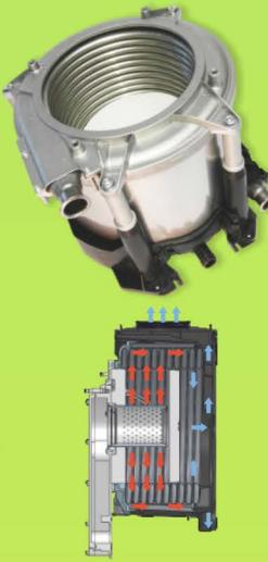
Noul schimbător de căldură ce echipează centrala MKDens, este un schimbător de căldură integrat și compact, cu o singură serpentină din oțel inoxidabil, cu secțiune ovală. Schimbătorul de căldură este compus dintr-o cameră de ardere cu o zonă de ardere, o zonă de condensare și un disc metalic izolat, care separă cele două zone.
