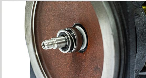
Garnitura mecanică: ceramică/grafit/NBR
